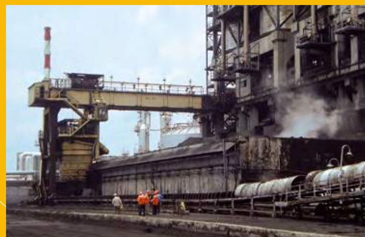
3 Grúa semi-pórtico para manipulación de coque de petróleo con cuchara de 10 m³, capacidad 25 t, luz 26,92 m, Dumai (Indonesia).
